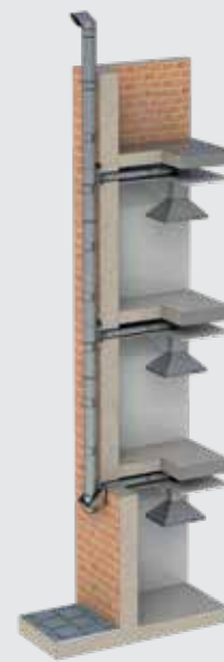
VENTILACIÓN CON CANALIZACIÓN INTERIOR
