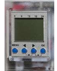
Unidad base de control termostático con salida para control de bomba y caldera.
