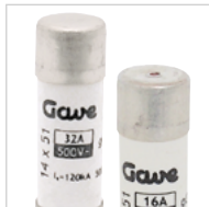
Cilíndricos UTE con o sin indicador de fusión. Curva de fusión gG de 0,5 a 125A Pág. 187
