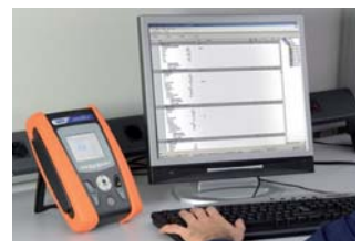
Transferencia de datos a PC a través de conexión óptica/USB u óptico/Wi-Fi
