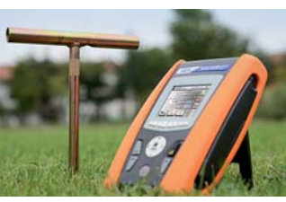
EARTH medida de la resistencia de tierra con picas (Telurómetro)
