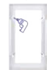
1- Fijar zócalo metálico a la pared
