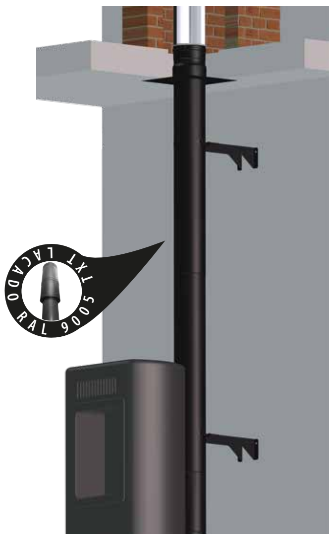
Dinak le aconseja el montaje con el sistema de acabado con un embellecedor 13D
